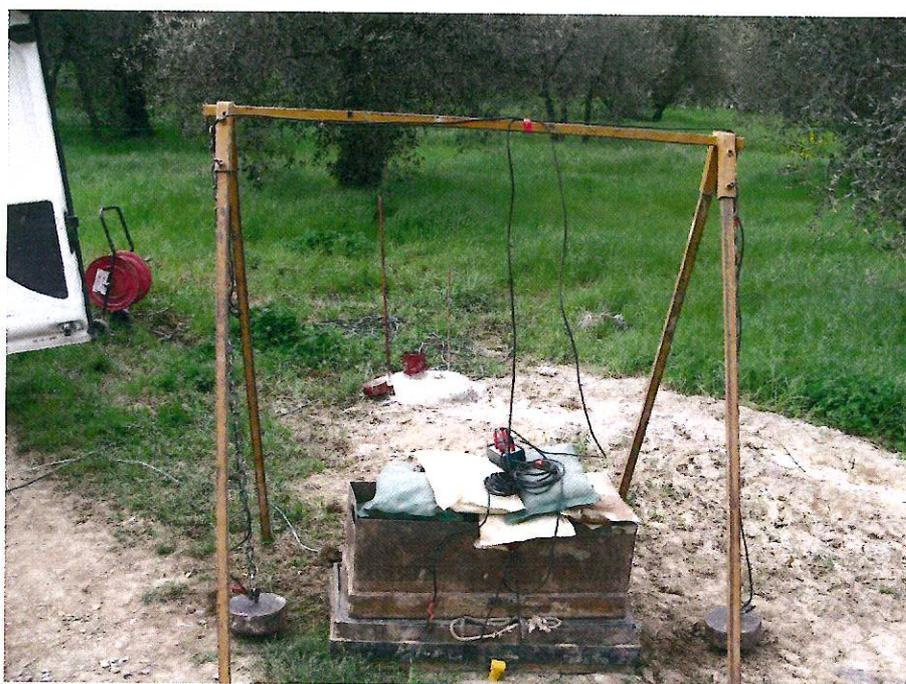
**Figura 2** – Il dispositivo di energizzazione utilizzato per la prova down-hole.
