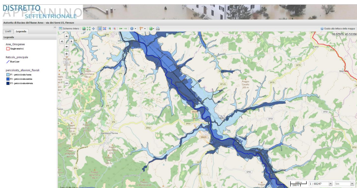
Figura 1 - Stralcio della carta di pericolosità idraulica del P.G.R.A. (Fonte: Autorità del Bacino del fiume Arno)
