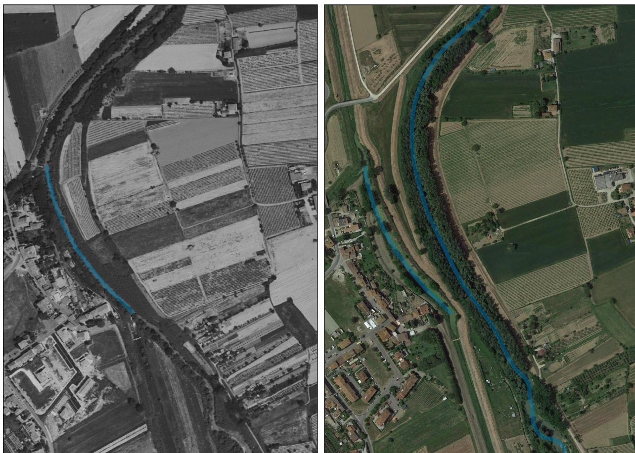
Figura 2: Deviazione del fiume Elsa in corrispondenza della frazione di Dogana. A sinistra l'ortofotocarta è datata al 1999. A destra la foto satellitare è datata al 2023.
